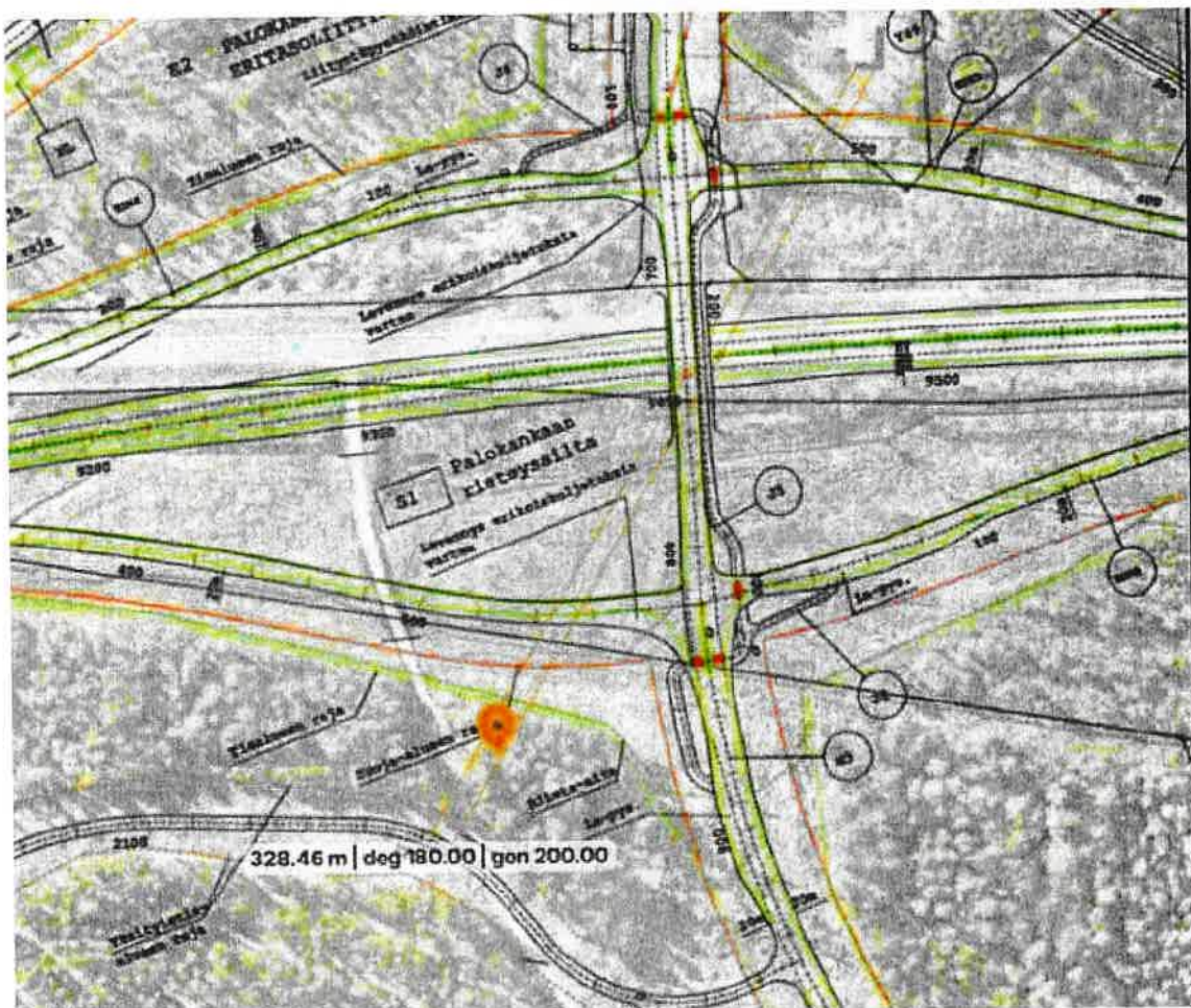
Kuva 3. Ote VT 5 tiesuunnitelmasta (Destia 2024), etäisyys lähimpään asuinkiinteistöön ottoalueen länsipuolella sijaitsevasta tielinjasta on yli 300 m.
