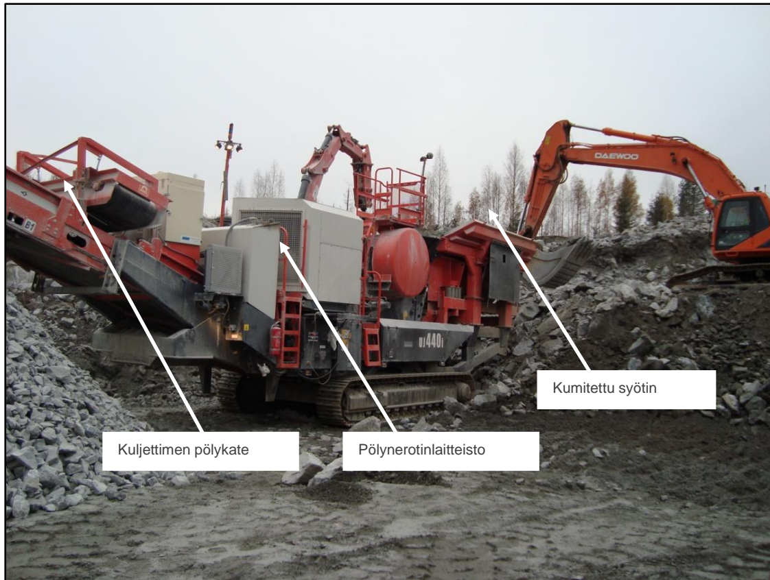
Kuva 6 Lokotrack-tyyppinen esimurskain (Sandvik UJ440i vm. 2008) kalliokiven murskauksessa [7]
